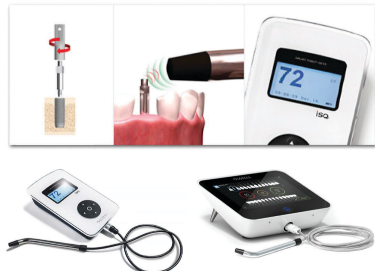
(그림1-3) Osstell을 이용한 ISQ 측정 방법(위), Osstell mentor(좌), Osstell IDX(DIO)(우)
